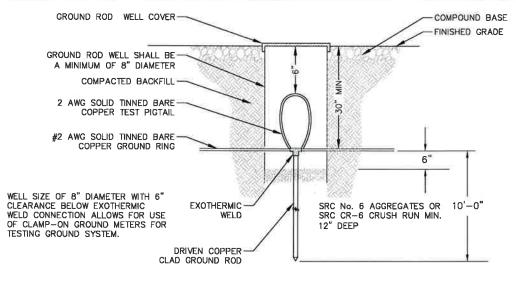
**GROUND ROD TEST WELL DETAIL**
