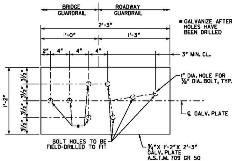
**GUARDRAIL CONNECTION PLATE DETAIL**
