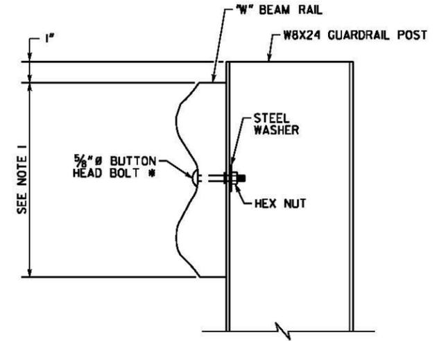
**GUARDRAIL CONNECTION DETAIL**
