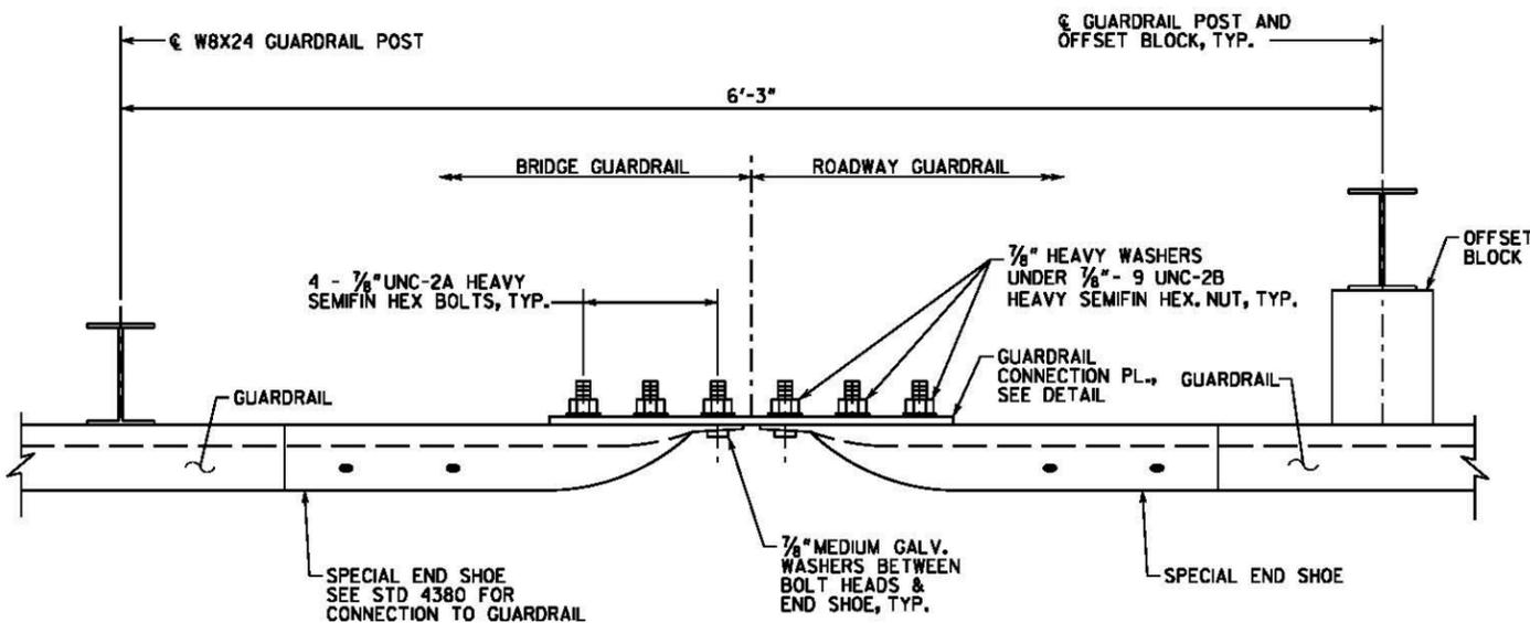
**GUARDRAIL CONNECTION DETAIL**
