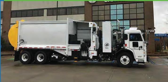
Camión con cargador lateral automatizado (ASL) de Sanitation Division
