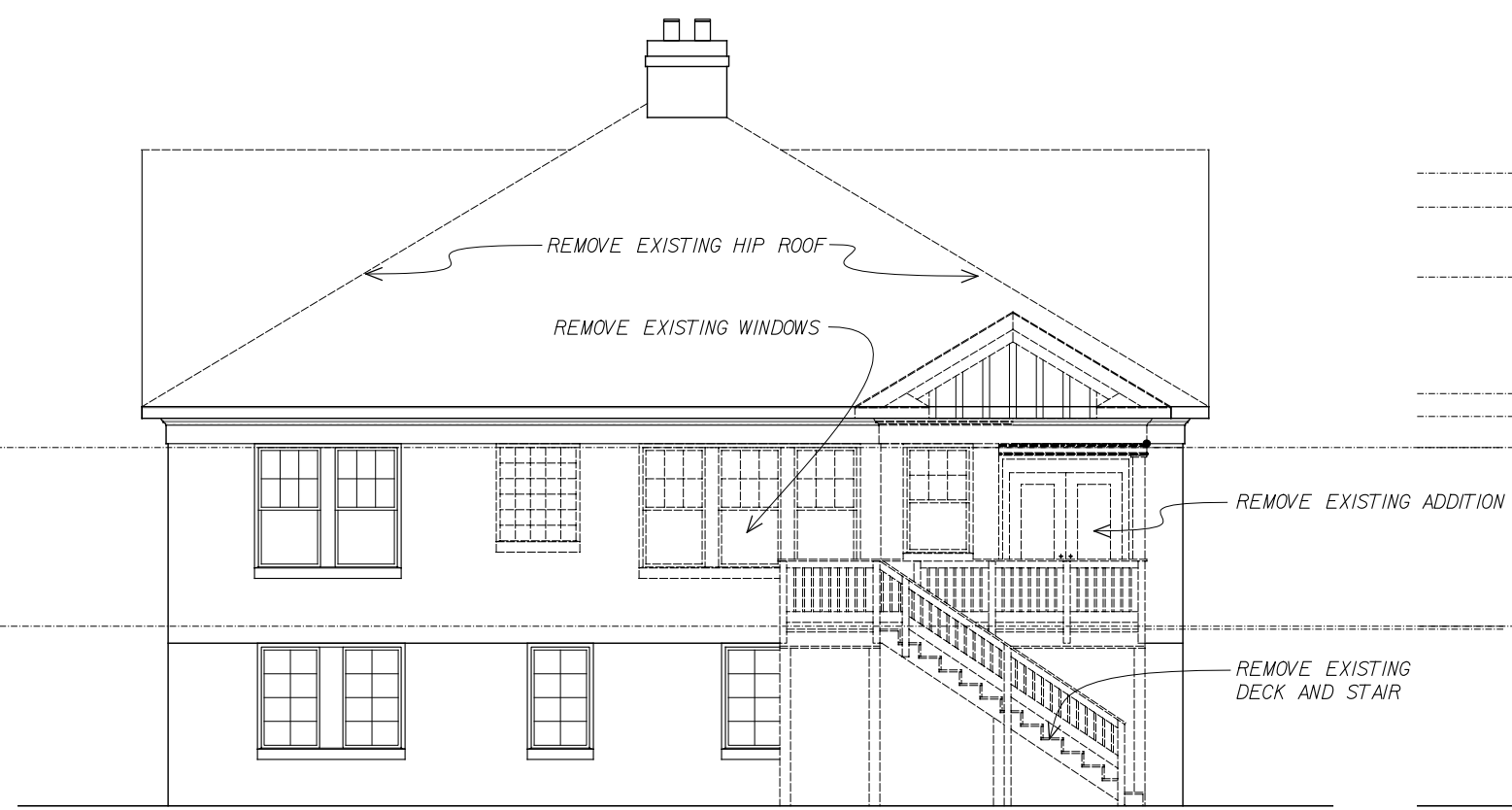
03 EXISTING REAR ELEVATION A-1.04 SCALE: 1/8" = 1'-0"
